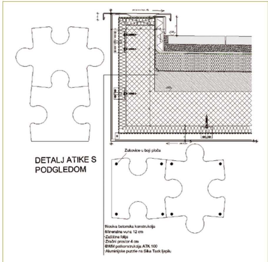
đu negorivih slojeva, ne postoji opasnost od požara niti prijenosa požara.
